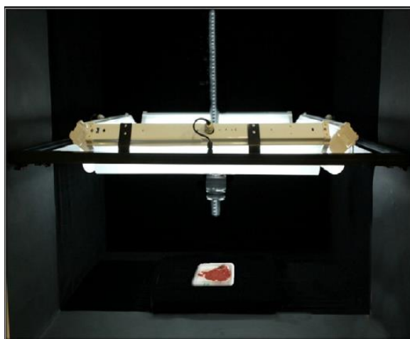
ภาพที่ 3 การติดตั้งระบบวิเคราะห์เชิงภาพถ่าย (CVS) ในการวิเคราะห์ค่าสีของเนื้อโค
